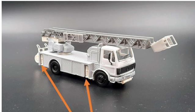
Bei der Aufnahme der BREKINA Stützen ist ein Fehler entstanden... die Aufnahme im Podest sitzt zu tief. Dieses ist aber leicht zu beheben, indem man die Aufnahme an der Stütze einkürzt und einfach etwas höher einklebt. Wenn der Stützteller plan geschliffen ist, lässt er sich stehend in das Podest einschieben und verkleben. So erreicht man, dass alle Stützen in der gleichen Höhe angebracht werden.
